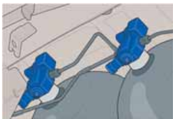
Elektromagnetyczne zawory odcinające na zbiornikach gazu
