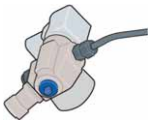
Ręczny zawór odcinający na zaworze głównym zbiornika
