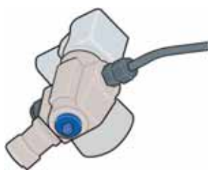
Ręczny zawór odcinający na zaworze głównym zbiornika
