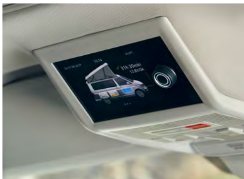
Kontrola zasilania w energię elektryczną i świeżą wodę
