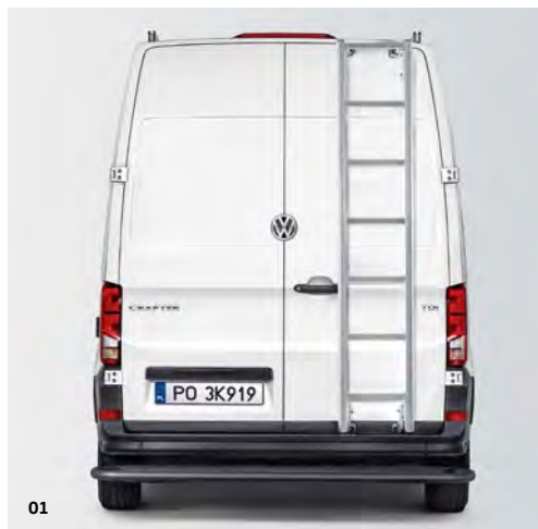
01 Drabinka na tylnych drzwiach. Ułatwia załadunek i rozładunek dachu. Dzięki przymocowaniu bezpośrednio do drzwi drabinka nie ogranicza możliwości ich otwierania. | FU |
