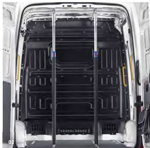
02 Dwa uchwyty mocujące. Umożliwiają bezpieczny transport różnych ładunków. Dają się szybko montować i demontować oraz dowolnie ustawiać w przedziale ładunkowym. | FU |
