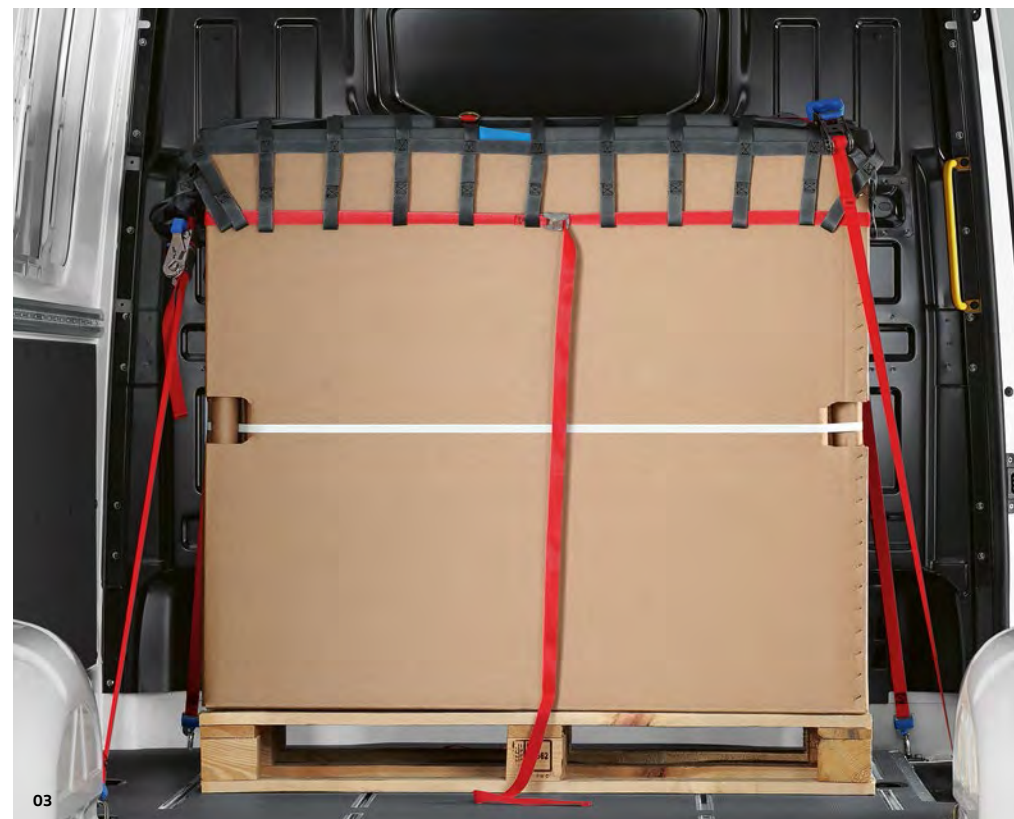
03 Siatka zabezpieczająca ładunek. Pas dookoła siatki zapewnia bezpieczne unieruchomienie ładunku. Karabińczyki z pasem zębatkowym można przytwierdzić do punktów mocowania w samochodzie lub – przy użyciu specjalnych elementów – do szyn w ścianach i podłodze. | FU |
